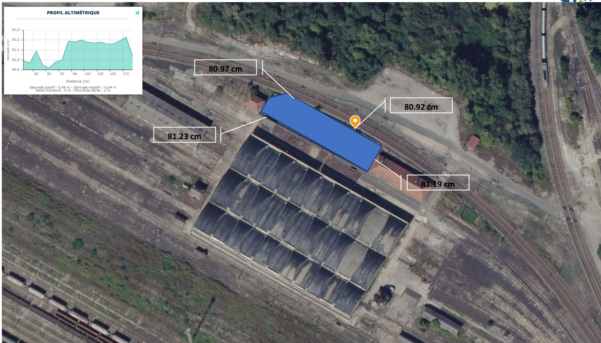
Planche n° XVI : Altimétrie relevée sur les surfaces dédiées au stockage provisoire des déchets (source : Géoportail)
